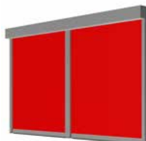
Mehrfeldanlage Mittig mit Einfach- oder Doppelführungsschiene
