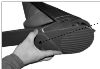
Abb. 20: Abziehen der Kappe (Abb. ähnlich)
