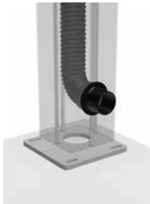
Detail Wasserspeier unten
