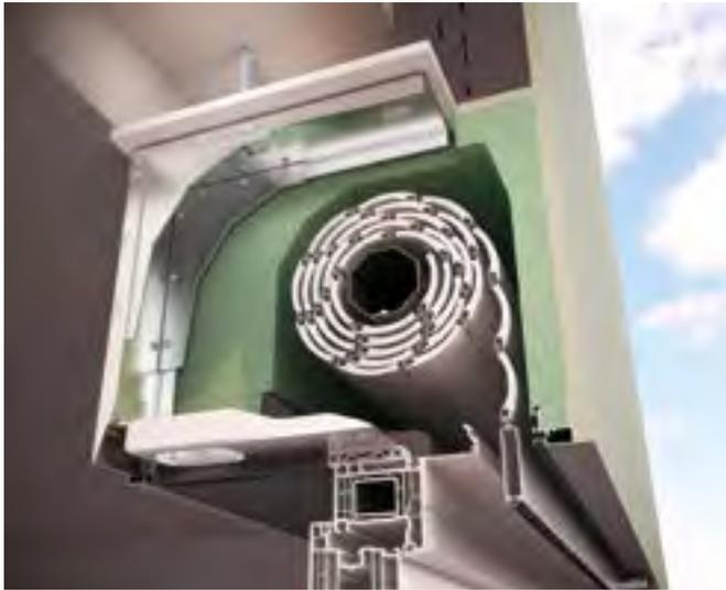
Die sicherste Befestigung des Fensters in Verbindung mit dem Combo XT bietet die Statikkonsole. Fest verbunden mit dem Baukörper kann die im Kasten integrierte Konsole sowohl Wind- als auch Stoßlasten ableiten. Die Anzahl der hierfür eingesetzten Konsolen richtet sich nach den Fenstermaßen und der Aufteilung der Fenster.
