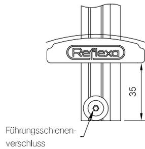
Detailschnitt EL 80NF Unterschiene
